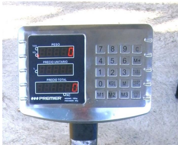
Romana electrónica utilizada para pesaje de las muestras de residuos
