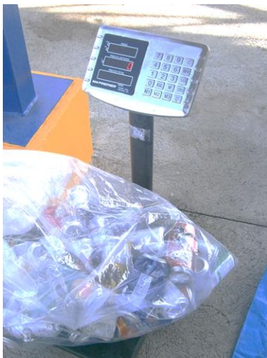
Romana electrónica utilizada para pesaje de las muestras de residuos
