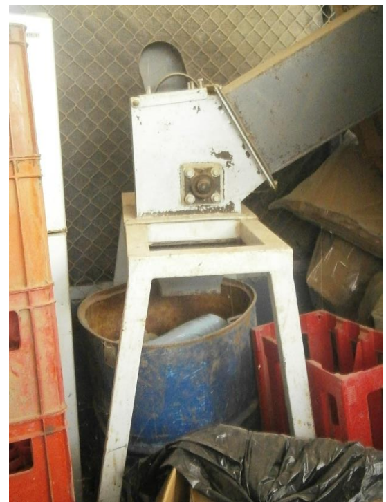
IZQ: Acumulación temporal de materiales valorizables, DER: Máquina quebradora de vidrio en desuso (sin motor)
